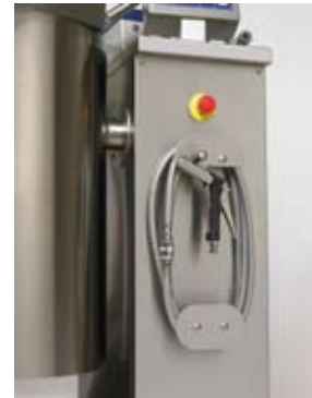
Slanghaspel gemonteerd vooraan de steunkolom en aansluiting bovenaan
