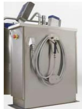
Slanghaspel en aansluiting aan de zijkant van de steunkolom
